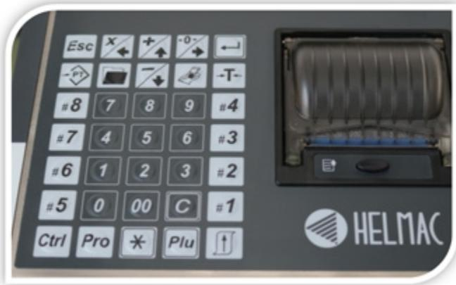
Neue mechanische Tastatur mit Klebeschutz für Funktionstasten, Folientastatur für PLUs, gut lesbar dank der praktischen Tasche
