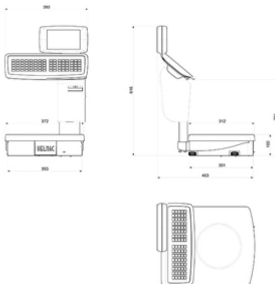
Abmessungen in mm Gewicht: 15,4 Kg
